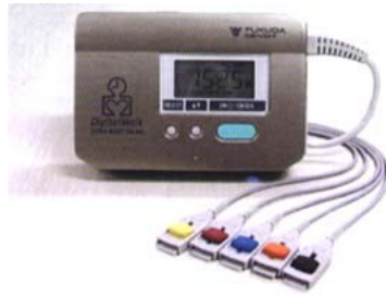
図3 ホルター心電図の記録装置
